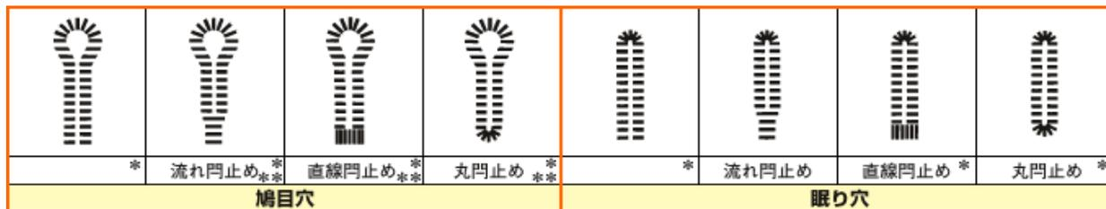
**電子制御化により、多彩な鳩目/眠り穴形状を操作パネルで選択・設定が可能です。**
